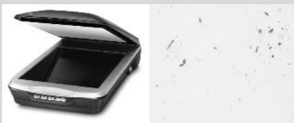
Numérisation du filtre sur scanner à plat
