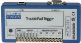
Dispositivo trigger +- 24V y hub USB3
