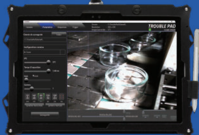
An der Halterung befestigte High-Speed Trouble Pad Kamera und Tablet-PC mit Software
