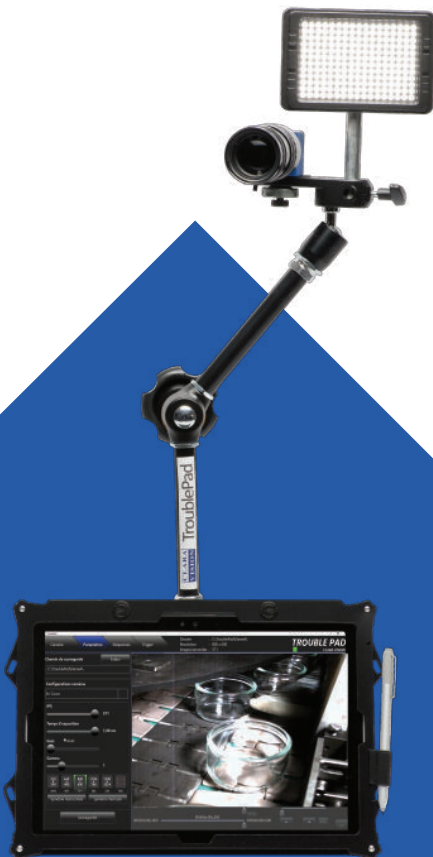
An der Halterung befestigte High-Speed Trouble Pad Kamera und Tablet-PC mit Software
