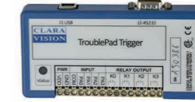
Dispositivo trigger +- 24V y hub USB3
