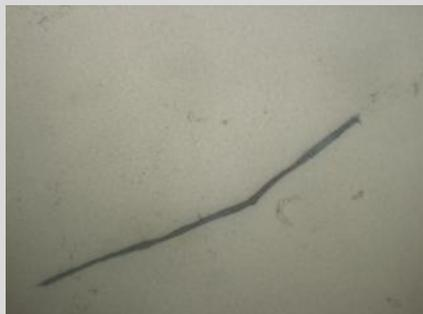
Fibre en surface d'une membrane
