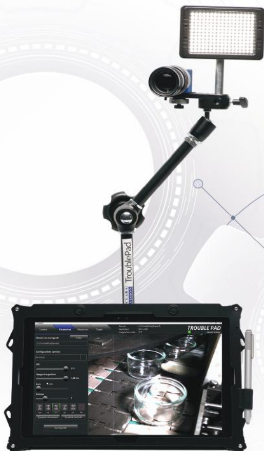
Caméra rapide TroublePad sur son bras de fixation et son logiciel sur tablette.
